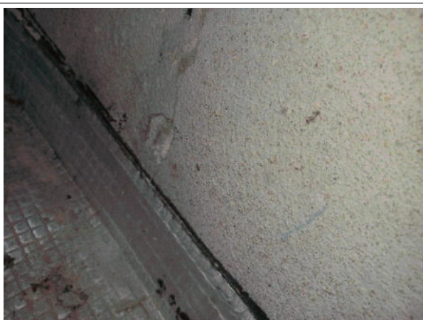
Prélèvement - 46 : EXT / Façades / Zone Tampon "Tour Terrasse" - Enduit- (Absence d'amiante)
