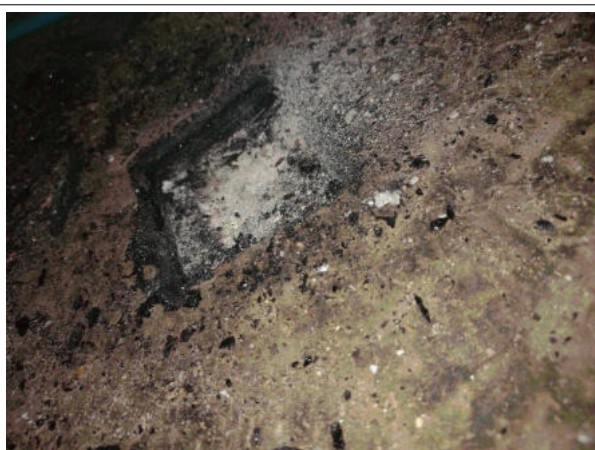
Prélèvement - 3 : INT / R+2 / Plateau de bureaux - Colle bitumineuse- (Absence d'amiante)
