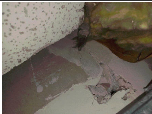
Prélèvement - 13 : INT / R+2 / Plateau de bureaux - Enduit de jointoiment de plaques de plâtre- (Absence d'amiante)
