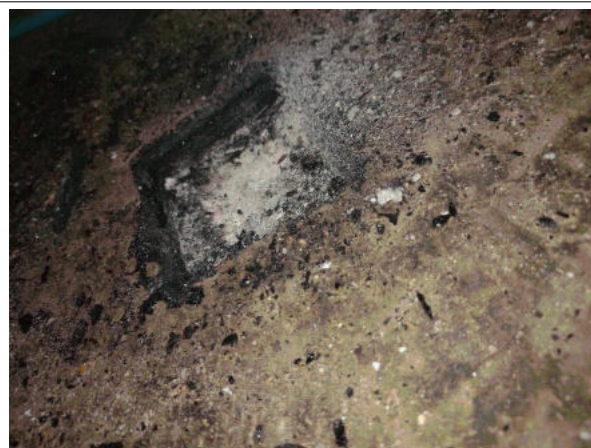
Prélèvement - 2 : INT / R+2 / Plateau de bureaux - Revêtement bitumineux- (Absence d'amiante)
