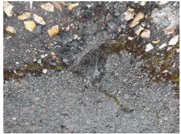
Prélèvement - 38 : EXT / Voirie / Zone arrière - Enrobé bitumineux- (Absence d'amiante)
