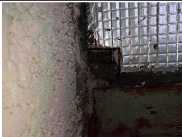
Prélèvement - 48 : EXT / Façades / Zone Tampon "Tour Terrasse" - Revêtement bitumineux- (Absence d'amiante)
