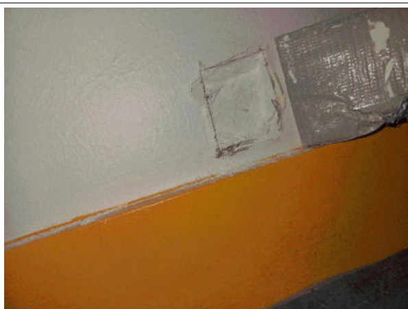
Prélèvement - 17 : INT / R+2 / Plateau de bureaux - Enduit- (Absence d'amiante)
