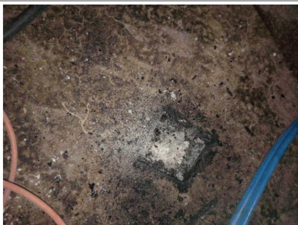
Prélèvement - 1 : INT / R+2 / Plateau de bureaux - Revêtement bitumineux- (Absence d'amiante)
