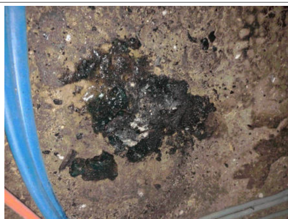
Prélèvement - 6 : INT / R+2 / Plateau de bureaux - Colle bitumineuse- (Absence d'amiante)
