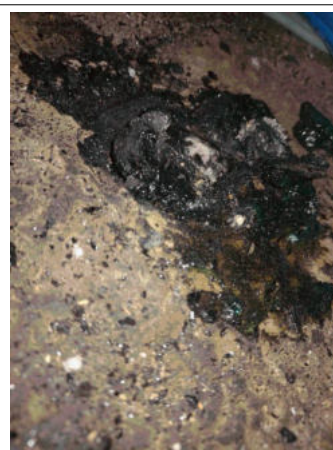
Prélèvement - 4 : INT / R+2 / Plateau de bureaux - Revêtement bitumineux- (Absence d'amiante)
