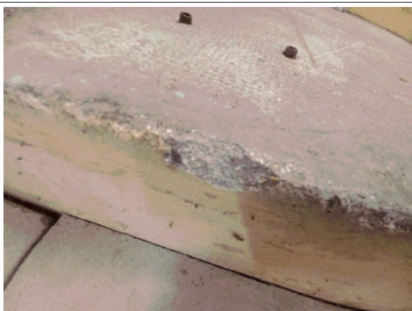
Prélèvement - 27 : INT / RDC / Local Transformateur - Chape maigre- (Absence d'amiante)
