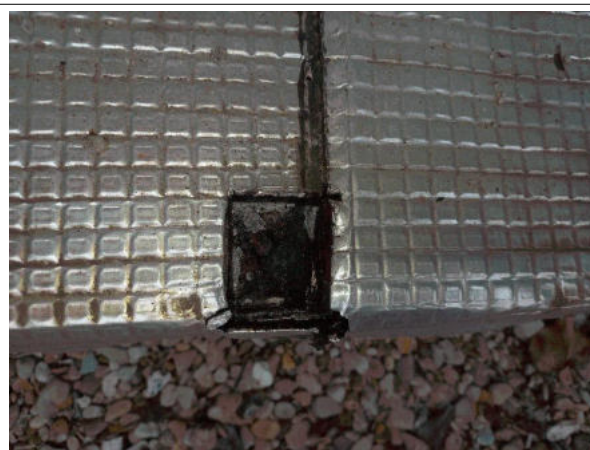
Prélèvement - 47 : EXT / Façades / Zone Tampon "Tour Terrasse" - Revêtement bitumineux- (Absence d'amiante)
