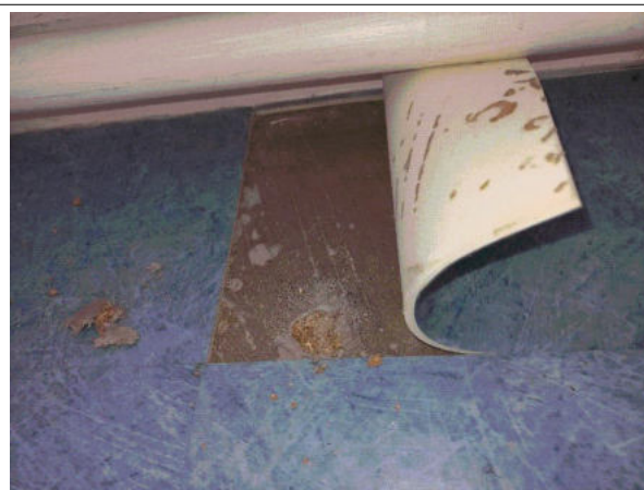
Prélèvement - 12 : INT / R+2 / Plateau de bureaux - Ragréage- (Absence d'amiante)
