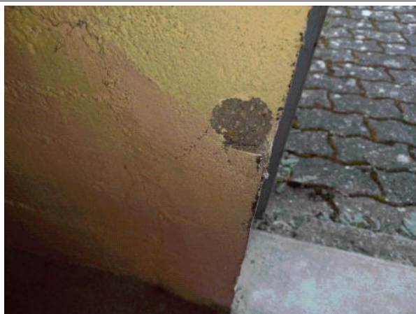
Prélèvement - 31 : INT / RDC / Local Transformateur - Enduit- (Absence d'amiante)
