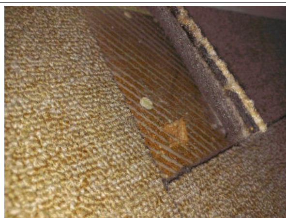
Prélèvement - 10 : INT / R+2 / Plateau de bureaux - Colle- (Absence d'amiante)
