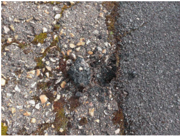
Prélèvement - 37 : EXT / Voirie / Zone arrière - Enrobé bitumineux- (Absence d'amiante)
